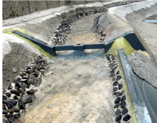
Figure 2: Modèle physique de l'ouvrage de dérivation, configuration retenue après optimisation (vue d'amont)
