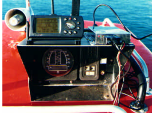
Fig. 2: Levé bathymétrique par échosondage
