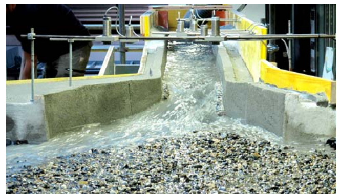
Figure 4 : Dépôts de sédiments dans le delta élargi lors de la phase de décrue de la crue Q 300 .
