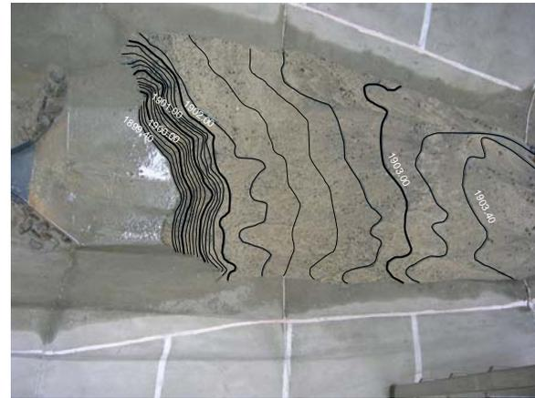
Figure 2: Courbes de niveaux du dépôt solide à la fin d'une période annuelle d'exploitation
