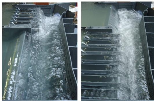
Figure 4 : Etude de l'impact des positions respectives clapet/PKweir pour  $Q_{5000}$
