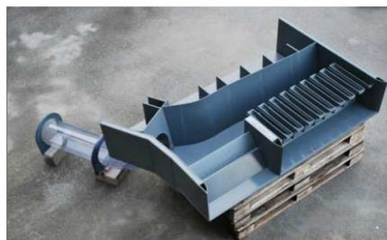
Figure 3 : Maquette de la partie amont de l'évacuateur
