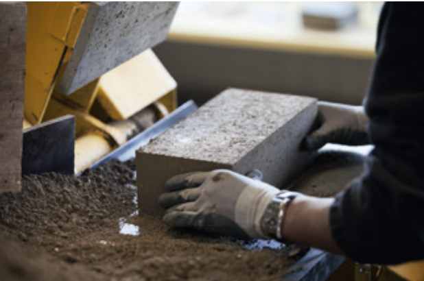
Filière terre Terrabloc est une entreprise qui réalise des constructions en blocs de terre crue conçus à partir de déblais terreux d'excavation de chantier. L'avantage est triple: réduction des terres à évacuer, fonctionnement en circuit court et réalisation de murs à très faible impact environnemental. Ces derniers respirent, ont des qualités thermiques et hygrométriques excellentes et apportent ainsi du confort, tout en ayant une texture très agréable. Ce matériau, particulièrement adapté pour l'intérieur, peut également être utilisé pour les façades extérieures, mais avec des précautions et un soin particulier à apporter lors de la mise en œuvre. En savoir plus : www.terrabloc.ch
