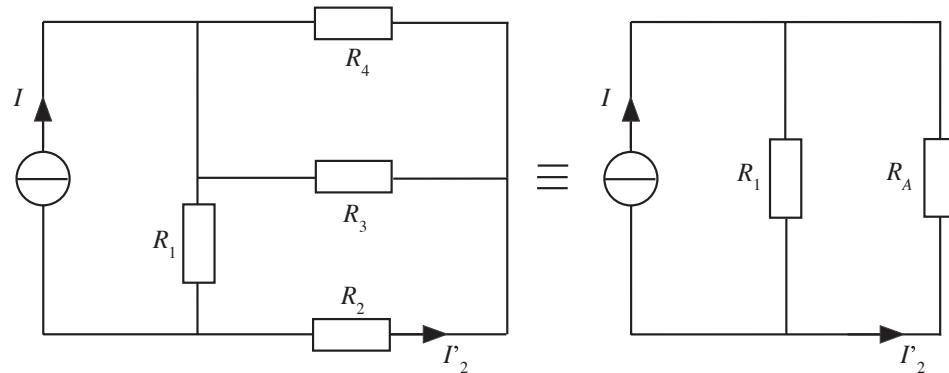
On a tout d'abord mis les résistances  $R_3$  et  $R_4$  en parallèle, puis la résistance équivalente en série avec  $R_2$  pour obtenir la résistance  $R_A$  suivante :
