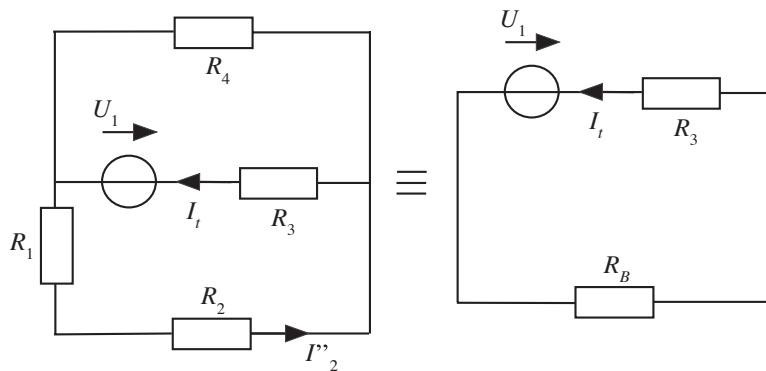
Dans une première étape, les deux résistances  $R_1$  et  $R_2$  sont mises en série puis en parallèle avec  $R_4$ , ce qui nous donne la résistance équivalente  $R_B$  qui vaut :
