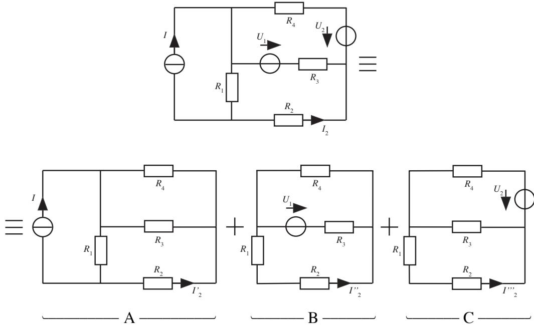
On résout les trois circuits A, B et C séparément :
