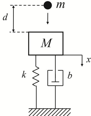
Il s'agit d'une balle en acier  $m$ , lâchée d'une hauteur  $d$ , qui tombe sur le centre d'une masse  $M$ . La balle est ensuite rattrapée après le premier rebondissement qui est supposé élastique. Le système est initialement au repos  $x(0) = 0$  et  $\dot{x}(0) = 0$ .
