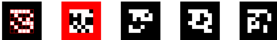
FIG. 3.3 – Exemples de marqueurs. En évidence sur le premier, l'identifiant unique, et sur le deuxième, le cadre.
