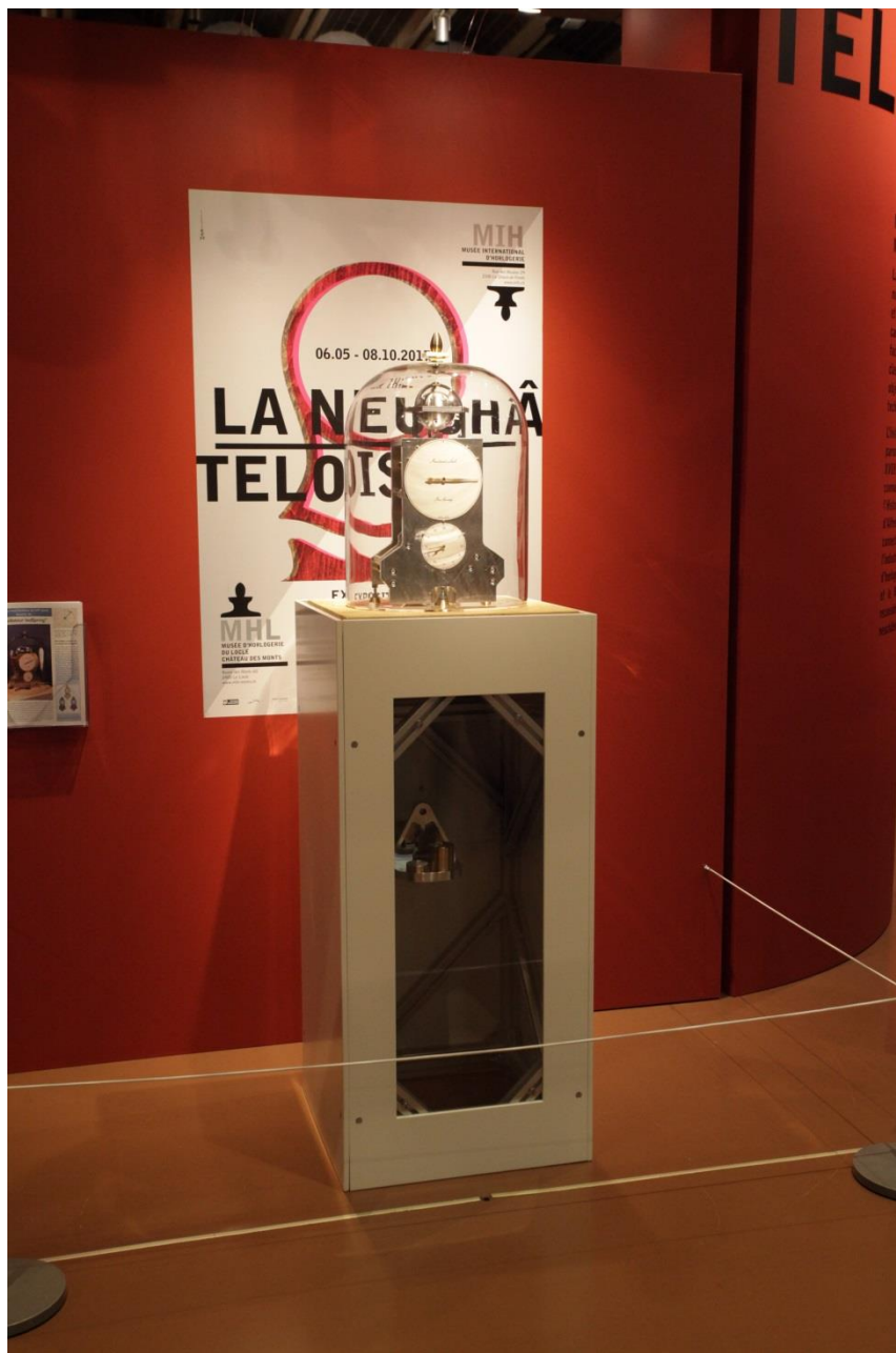
Horloge neuchâteloise développée au sein du laboratoire de conception micromécanique et horlogère (Instant-Lab) à Neuchâtel (Microcity) dotée de l'oscillateur unidirectionnel IsoSpring® qui fonctionne sans échappement. Photo : Musée international d'horlogerie.
