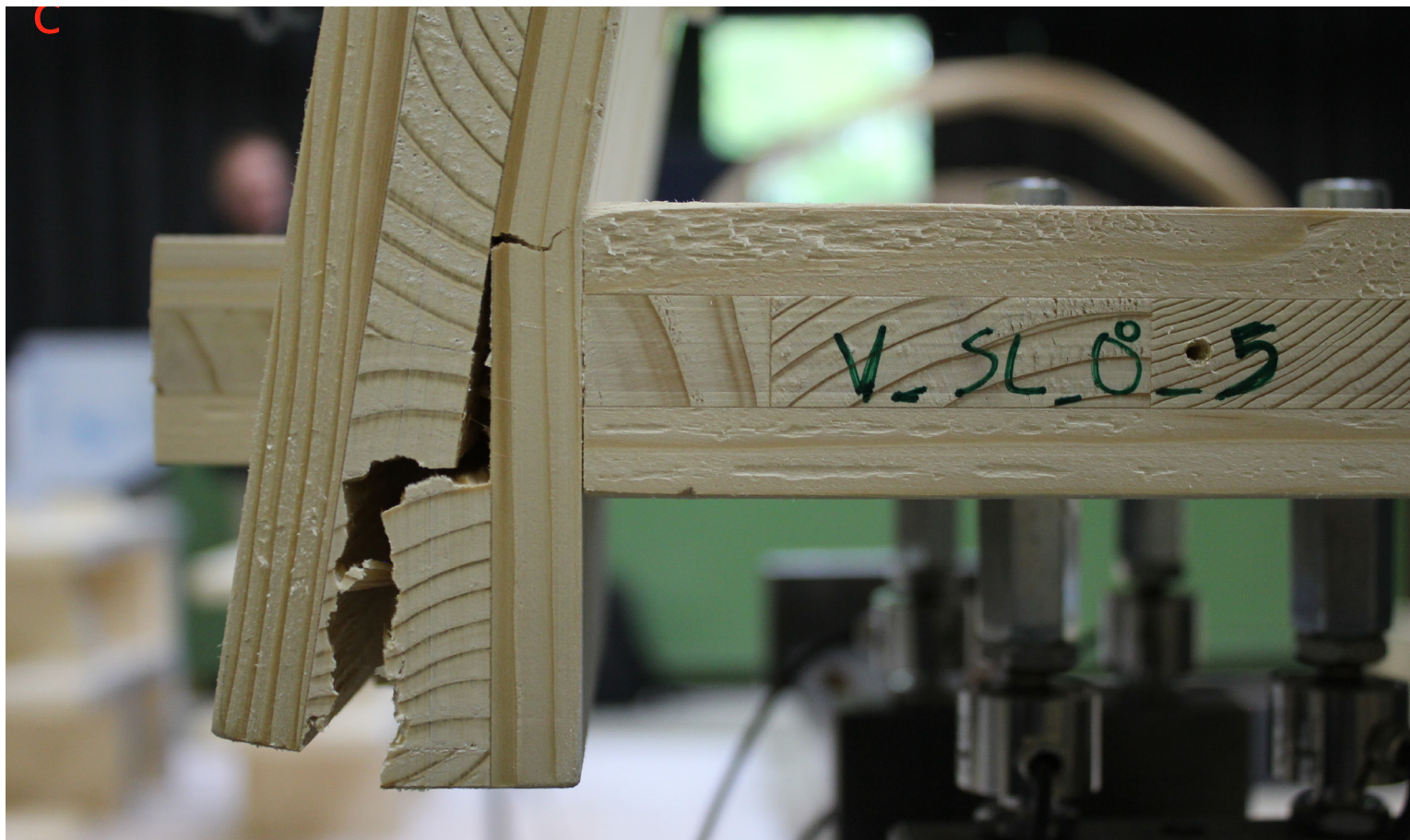
Mode de rupture du tenon lors d’un essai d’un panneau tri-ply dans une connexion à simple couche
