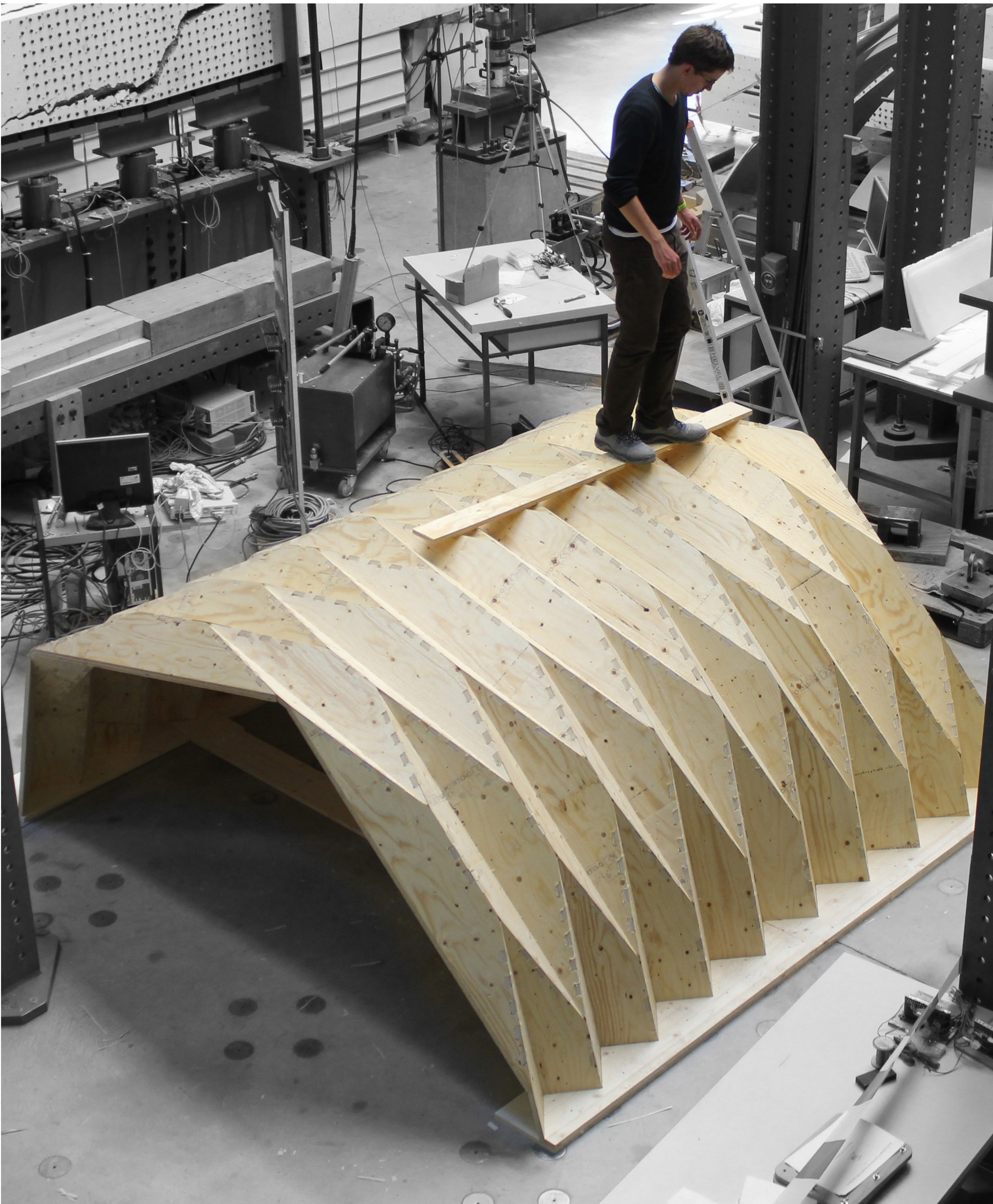
Prototype d’une structure plissées en panneaux en bois utilisant des joints à rainures-languettes multiples à un degré de liberté.
