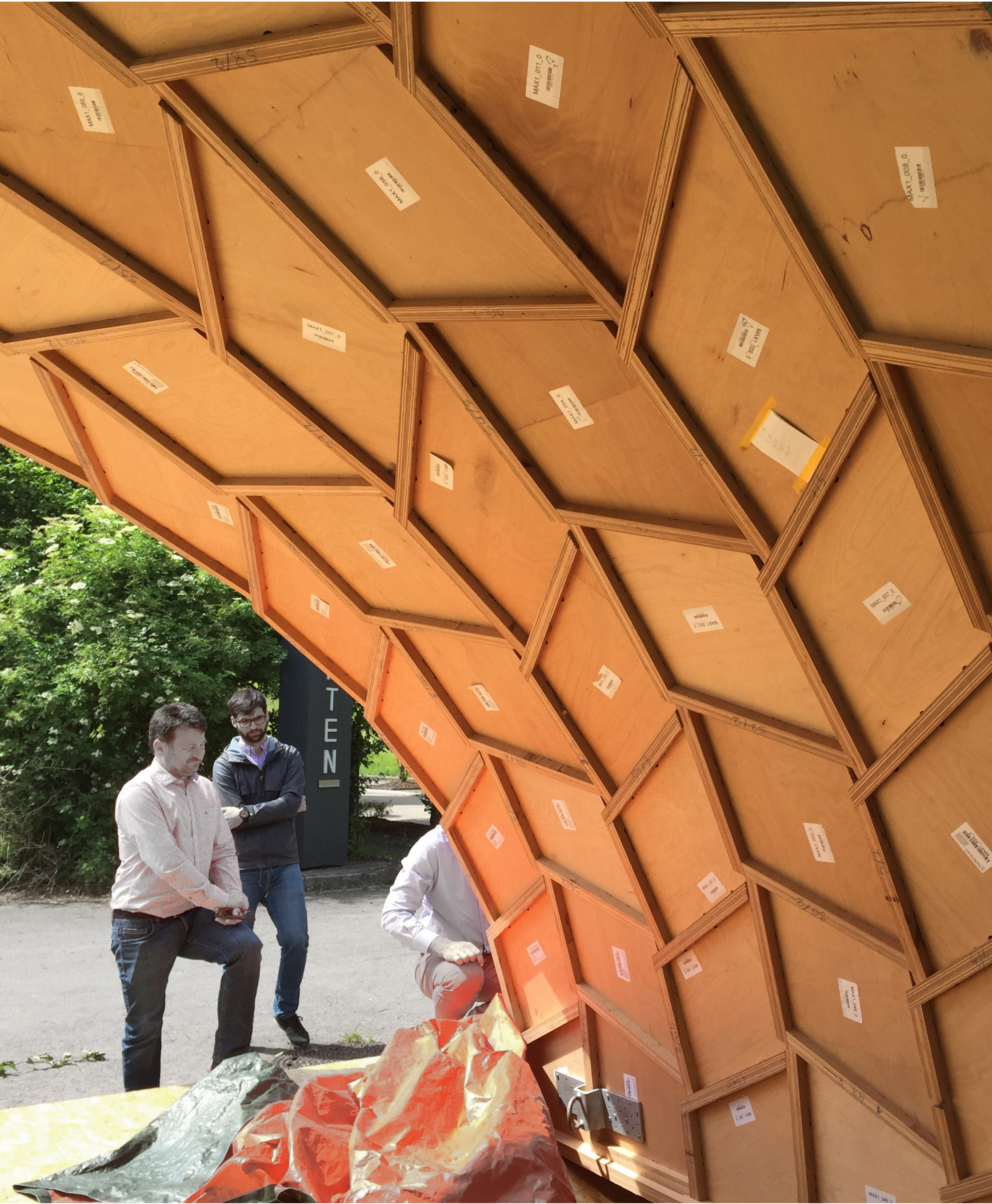
Prototype d’une voûte du projet de Annen à échelle 1/2.
