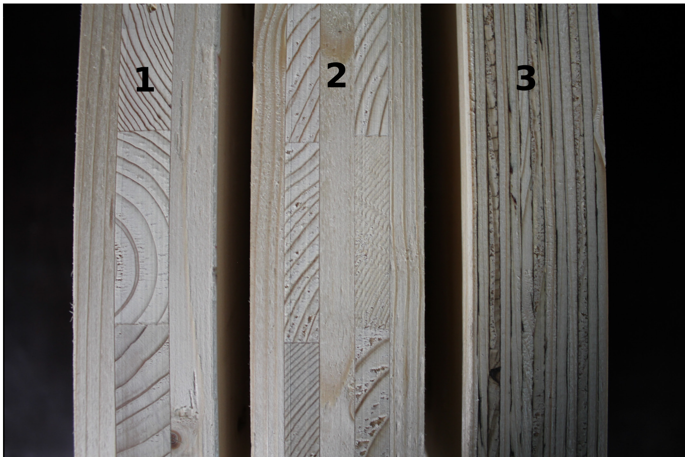
Echantillon des panneaux en bois investis : tri-ply, cinq-ply et stratifié.
