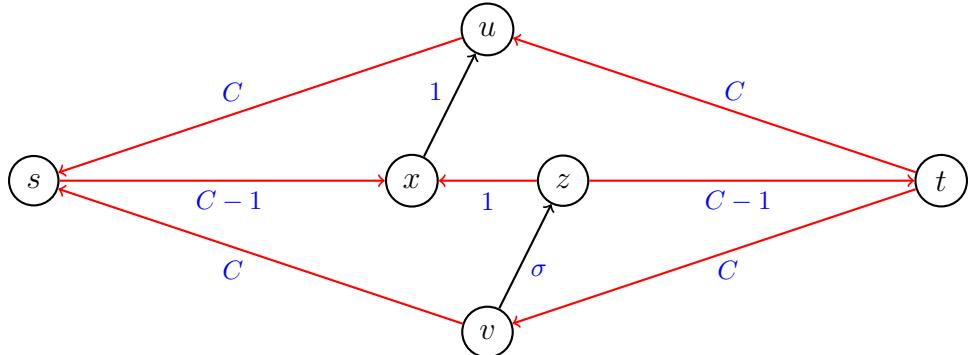
La coupe définie par  $\{s, x\}$  a une capacité de  $1 + 2C$ , donc le flot est maximal. Considérons maintenant un choix des chemins améliorants moins avantageux. On commence avec le chemin  $s-x-z-t$  et on obtient le graphe résiduel suivant :
