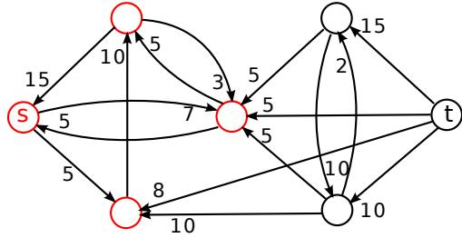
$t$  n'est plus accessible depuis  $s$  dans le graphe résiduel. Donc le flot est maximal et sa valeur est 20. L'ensemble  $U = \{s, u, v, x\}$  qui définit la coupe minimale de  $s-t$  est marquée en rouge. Le flot maximal est indiqué dans le graphe suivant :
