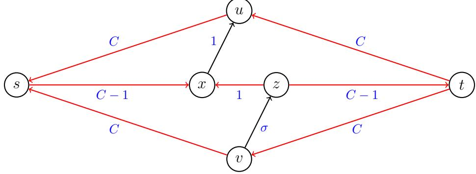
La coupe définie par  $\{s, x, u\}$  a une capacité de  $1 + 2C$ , donc le flot est maximal. Considérons maintenant un choix des chemins améliorants moins avantageux. On commence avec le chemin  $s-x-z-t$  et on obtient le graphe résiduel suivant :
