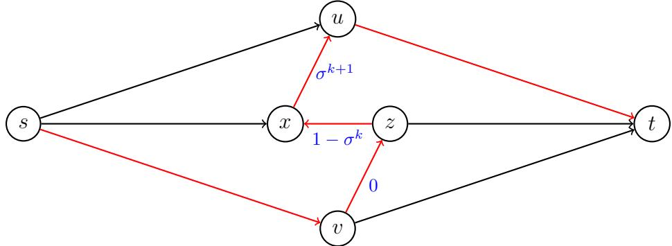
On augmente alors le flot de  $\sigma^k$  et on obtient des capacités  $\sigma^{k+1}, \sigma^k, 0$ .
