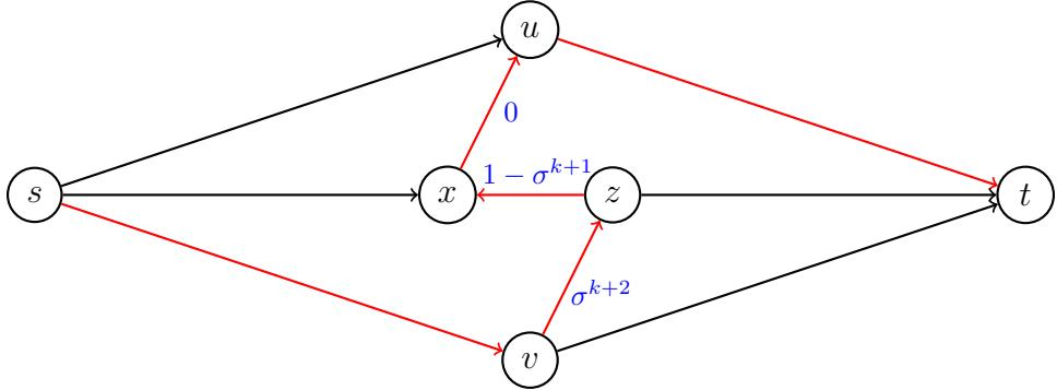
Finalement, on prend un chemin améliorant  $P$  pour obtenir une augmentation de  $\sigma^{k+1}$  et des capacités  $\sigma^{k+1}, 0, \sigma^{k+2}$  :
