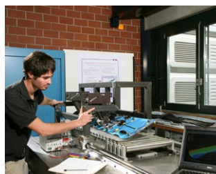
Banc d'essai du snowboard instrumenté.
