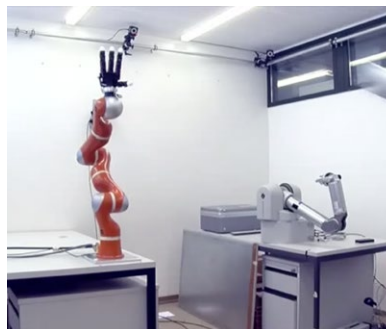
Bras robotique du laboratoire programmé pour capturer des objets en vol.
