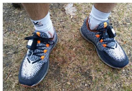
Unités de mesure inertielles portées au pied (Physilog 5).
