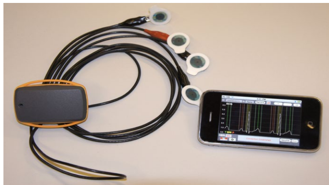
Prototypé de laboratoire avec électrodes séparées.
