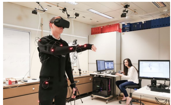
Ce dispositif expérimental sert à quantifier la sensibilité humaine à des distorsions de notre posture lorsqu'elle est représentée dans le casque de réalité virtuelle.
