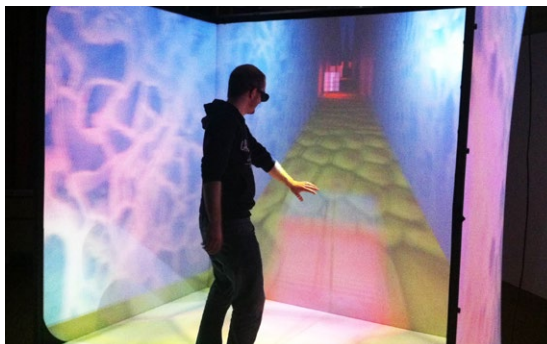
Interaction avec des lunettes stéréo dans un système multi-écrans.
