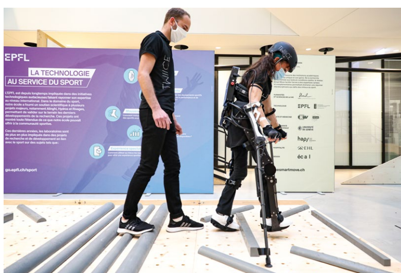
L'exosquelette Twice One permet à une personne atteinte de paraplégie complète de retrouver le monde vertical et la capacité de marcher, grâce à des moteurs aux articulations.
