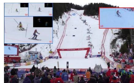
La solution RayShaper capturant toute la piste de ski de la Coupe du monde FIS avec un système unique fournissant automatiquement (a, b) un suivi de mise au point de haute qualité et une analyse des poses, (c) et une compétition virtuelle en tête-à-tête. (d) La diffusion traditionnelle capte souvent le dos des skieurs.
