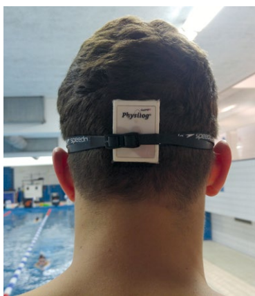
Capteur de mesure inertielle fixé sur la tête.
