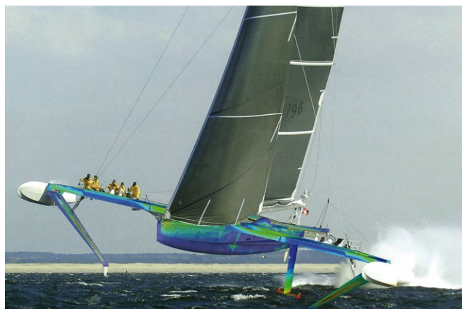
Simulation des contraintes et des déformations sur l'Hydroptère.
