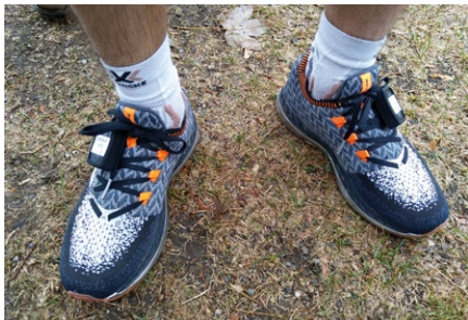
Unités de mesure inertielles portées au pied (Physilog 5).
