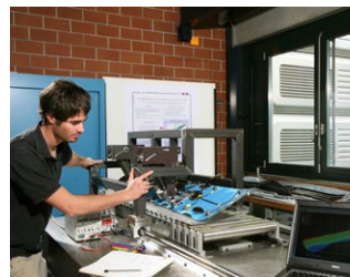
Banc d'essai du snowboard instrumenté.
