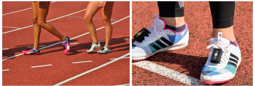
Unités de mesure inertes portées au pieds (Physiolog 5).
