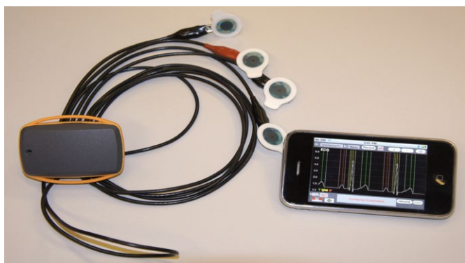
Prototype de laboratoire avec électrodes séparées.
