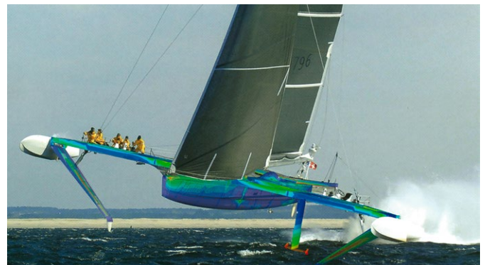
Simulation des contraintes et des déformations sur l'Hydroptère.
