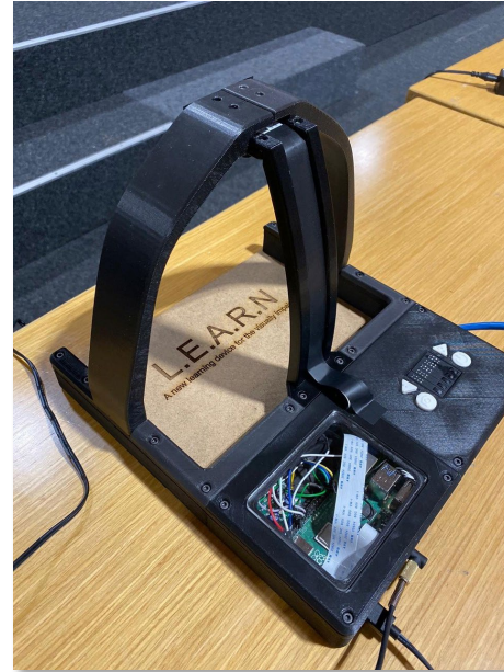
Prototype avec découpe et gravure laser, impression 3D et électronique
