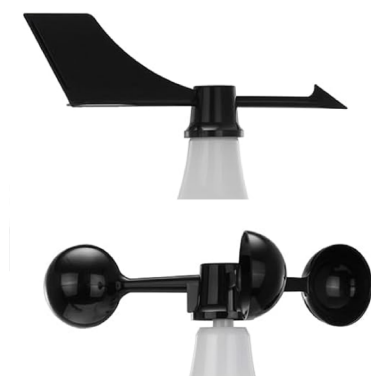
Abbildung 1.6: Sensor für Windrichtung (Windfahne, oben) und -geschwindigkeit (Anemometer, unten).
