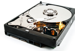
Abbildung 13.6: Festplatte, deren Gehäuse Schutzhülle entfernt wurde.
