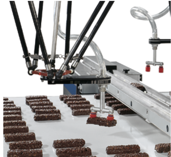
Abbildung 5.2: Delta Roboter am Fließband [Reymond Clavel, EPFL]
