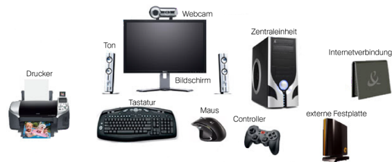
Abbildung 13.2: Eingabegeräte (Webcam, Tastatur, Maus, Joystick, Modem), Ausgabegeräte (Bildschirm, Ton, Drucker), die Zentraleinheit und ein Speichermedium.
