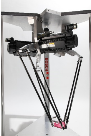
Abbildung 5-2 Delta Roboter (Alain Herzog, EPFL)
