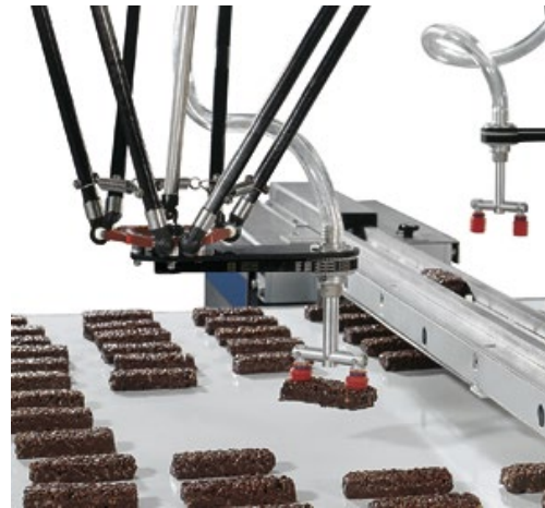
Abbildung 5-4 Delta Roboter am Fließband (Reymond Clavel, EPFL)
