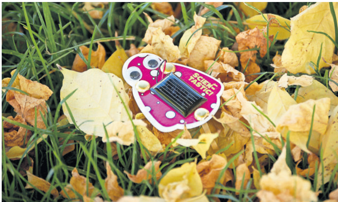
La bête est capable de se déplacer sans pile, à la seule force de l'énergie solaire. Son trajet dépend de la forme que l'on donnera à ses pattes.
