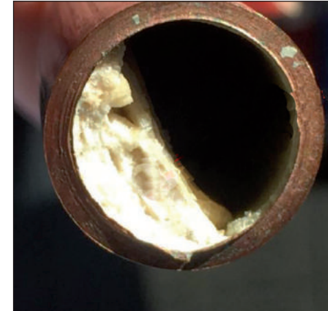
Dépôt calcaire bouchant la tuyauterie
