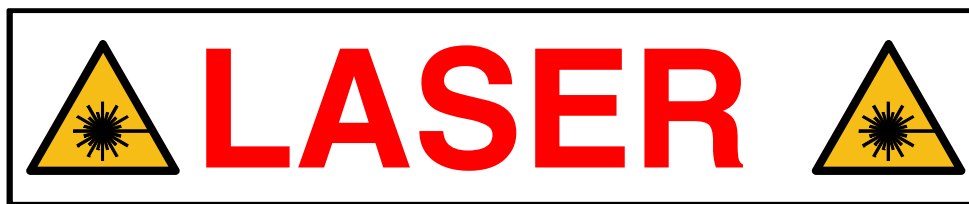
Figure 5 Panneau d'avertissement de danger laser. Fond blanc, lettres rouges et symbole de danger ISO 7010.
