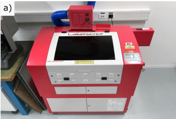
Figure 1 a) Machine à laser intégré avec verrouillage; Figure 1 b) installation fermée sans verrouillage.
