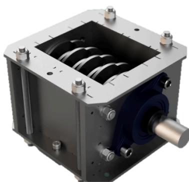
Cette étape nécessite une première machine : la déchiqueteuse. Cette machine utilise une série de lames afin d'écraser les chutes de plastique afin d'obtenir de
