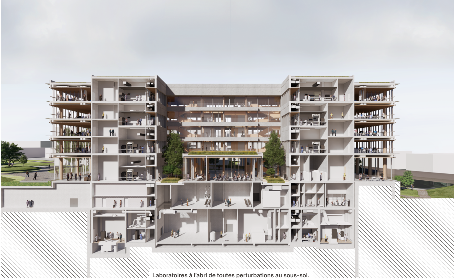
Laboratoires à l'abri de toutes perturbations au sous-sol.
