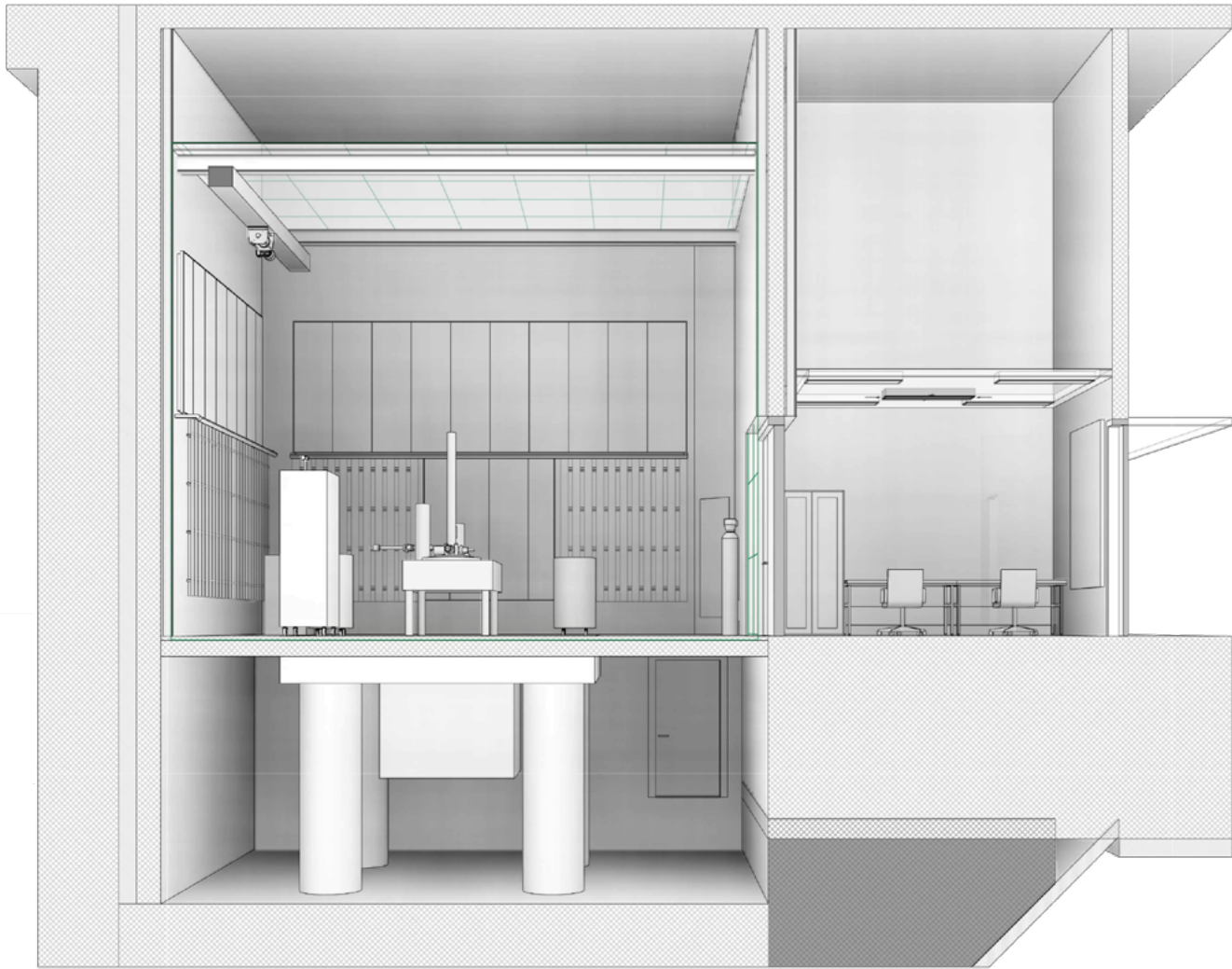
Plateforme anti-vibration dans une salle située au sous-sol accueillant un microscope à effet tunnel.
