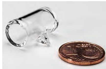
Rubidium vapour cell atomic clock
